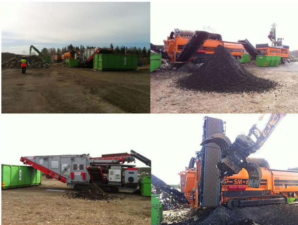
Рис. 4 Кучи с несортированным мусором и отдельные кучи после механической сепарации. Изображение справа показывает магнитную сепарацию мелкой фракции металла и почвы.
