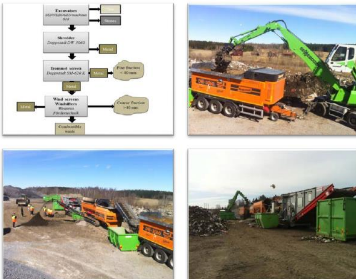
Рис. 3 Механизированный процесс, действующий на раскопке полигона Катринехольм в Швеции. Воздушный грохот, барабанный грохот, машина для предварительного дробления, предварительная сортировка экскаватором.
