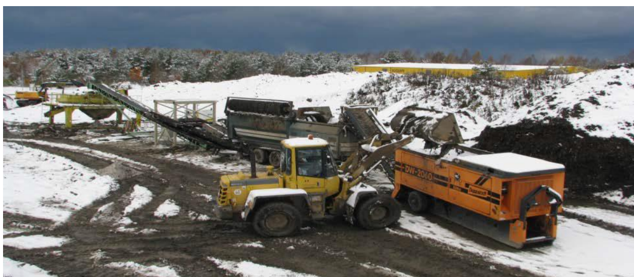
Рис. 2. Оборудование, использованное на свалке Кудьяпе. Фронтальный погрузчик, машина для предварительного дробления, барабанный грохот и конвейер.
