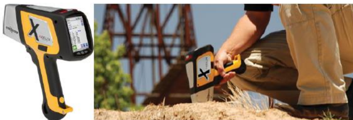
Рис. 5: мелкая фракция, откуда производился отбор образцов; рентгенофлуоресцентный ручной анализатор. Такие анализаторы использовались на территории свалки для анализа содержания металла в мелкой фракции мусора.
