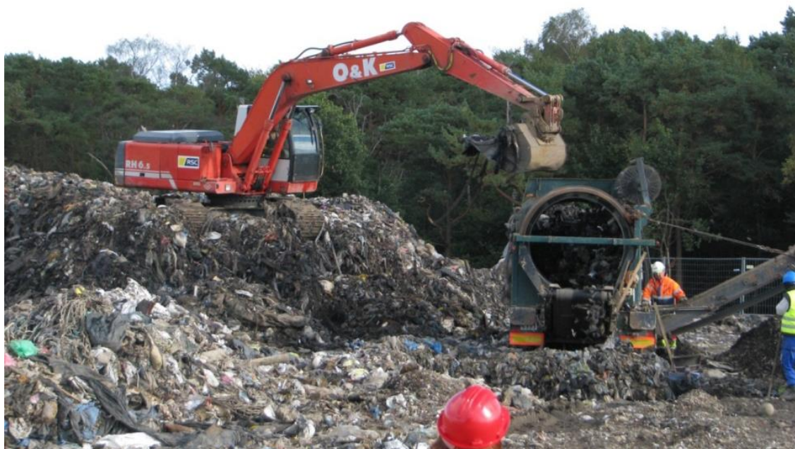
Рис. 1 Экскаватор загружает мусором барабанный грохот.
